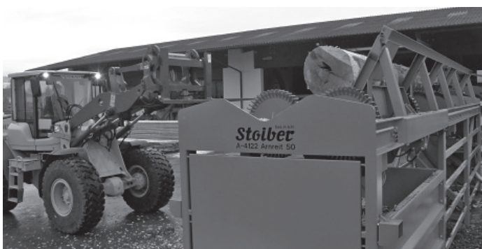
Beschickung mittels Radlader und vollautomatischer Betrieb über Fernbedienung
