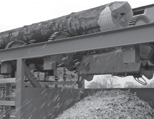
Wurzelreduzierer für gute Reduzierqualität bei geringem Strombedarf
