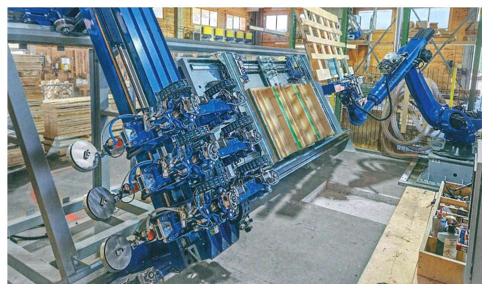
Die Paletten werden vollautomatisch vernagelt und abgestapelt. Mit sechs einzeln steuerbaren Nagelgeräten ist die Nagelbrücke ausgesprochen flexibel
