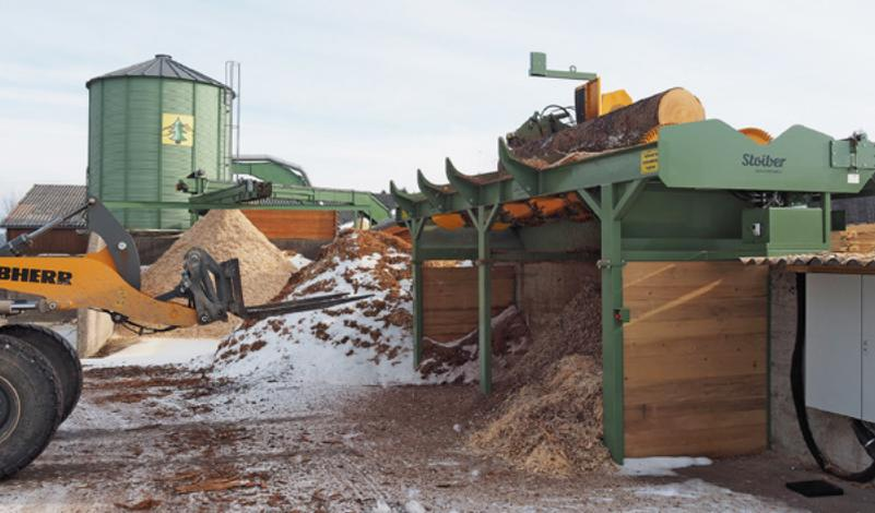
Der Mitarbeiter gibt die Stämme per Radlader auf die neue Fräskopfent-rindung samt eines Wurzelreduzierers von Stoiber auf
