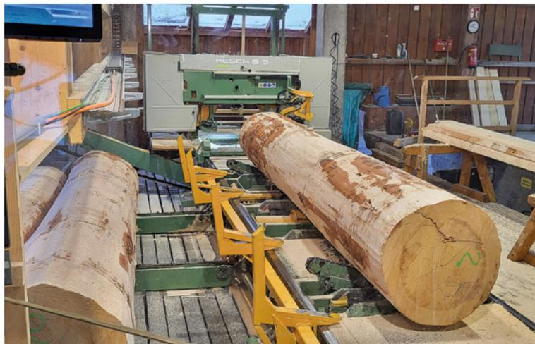
Die perfekt entrindeten Stämme gelangen im Anschluss zum Einschnitt auf der Blockbandsäge
